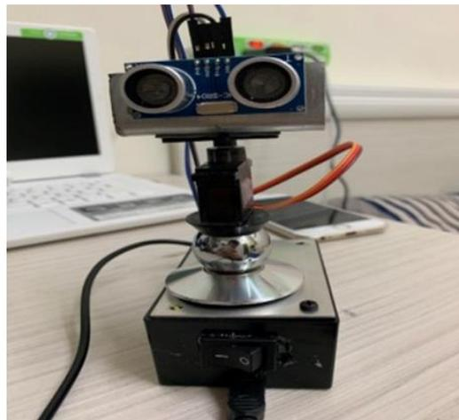
圖 2 自製超音波測距裝置（包含超音波模組、旋轉馬達、底部盒中有 Arduino 與藍芽通訊晶片）。超音波模組仰角可以調整。
