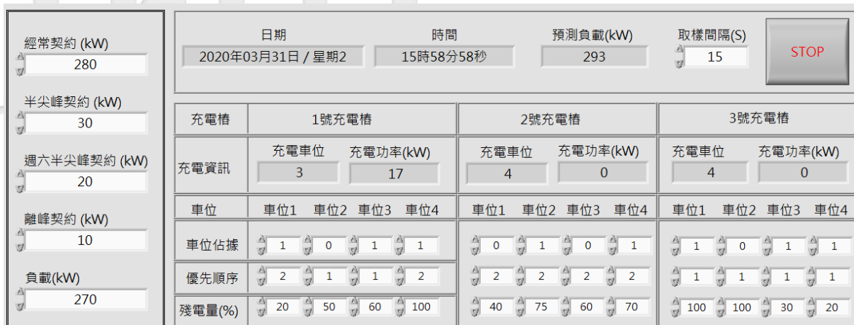
圖六.改變模擬電動車充電優先順序的測試結果
